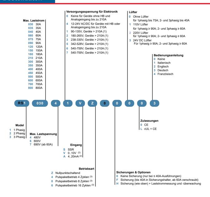
(1) Bei Geräten >210A muss die Lastspannung im angegebenen Bereich lieger
