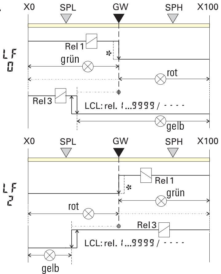
Das Relais 1 wird beim Verlassen des Alarm- bzw. Begrenzerbereichs verriegelt. Die Rückstellung (\*) kann wie beschrieben durchgeführt werden (→ **Rückstellung**), der externe Kontakt wird jedoch statisch ausgewertet. Ein ständig geschlossener Kontakt führt zu sofortiger Rückstellung.
