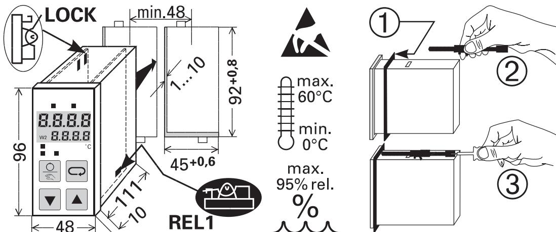
Mit der Dichtung ① zwischen Front und Schalttafel erhält die Tafelfront die Schutzart IP 54. Zum Zugriff auf die Drahtschalter REL1 und LOCK muß der Geräteeinschub mit kräftigem Zug an den Aussparungen des Frontrahmens aus dem Gehäuse gezogen werden.
