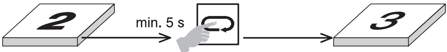
Nach Übergang in die Konfigurationsebene zeigt die 1. Anzeigenzeile **Conf** und die 2. Zeile das Konfigurationswort **0x00**.
