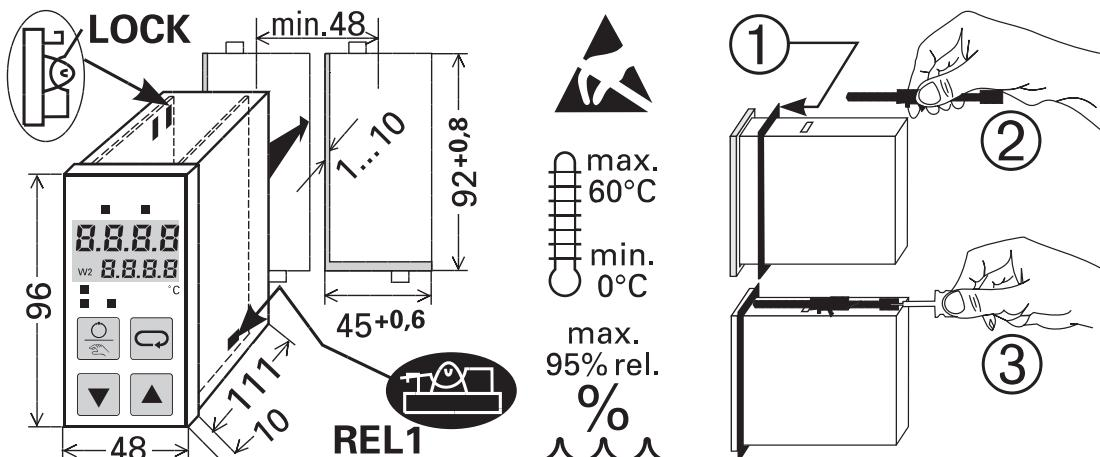
Un joint d'étanchéité ① entre la face avant et le panneau permet au panneau une protection selon IP 54. Pour accéder aux contacts à crochet REL1 et LOCK, saisir le module par les découpes sup. et inf. et l'enlever du boîtier en le tirant vers l'avant.
