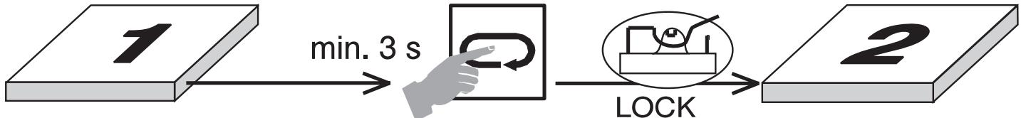
Lorsque le contact à crochet **LOCK** est ouvert, le passage en «paramétrage» est autorisé. L'affichage des paramètres s'effectue avec le symbole dans la 1<sup>o</sup> et la valeur dans la 2<sup>o</sup> ligne.
