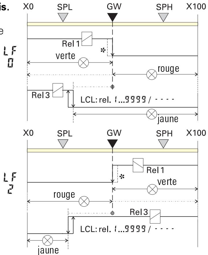
Le relais 1 est bloqué lorsque la plage d'alarme ou de limitation est quittée. L'annulation (\*) peut se faire comme décrit ( $\rightarrow$  Annulation), cependant, le contact externe est évalué statiquement. Un contact fermé continuellement provoque l'annulation immédiate.
