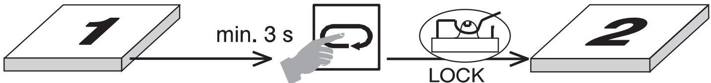
**☞** Bei offnem Drahtschalter **LOCK** ist der Übergang in die Parameterebene möglich. Das Parameter-Symbol wird in der 1. Zeile und der Wert in der 2. Zeile angezeigt.
