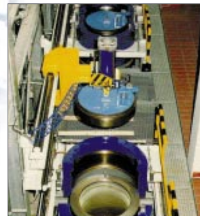
Produktionsanlage mit drei Extraktoren zu je 500 Liter und über 400 bar Extraktionsdruck zur Extraktion von Gewürzen/Foto: Uhde
